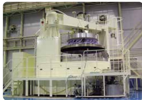
● 研磨装置 ガラス基板の大型化に合わせて大型研磨装置や特殊な研磨装置に特化して設計・製造しています。
