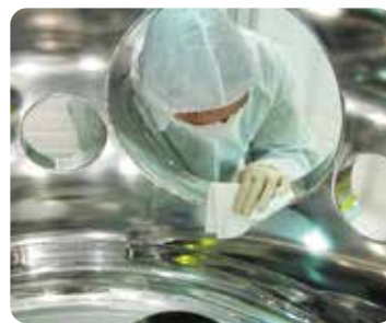
● 研磨技術 「電解複合研磨」や次世代の精密研磨技術「Juno Process」を駆使し、ナノレベルの平滑性と高い均質性、耐食性、防汚性をご提供します。
