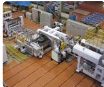
● 高品質フィルム・シート向け製造装置 独自開発の金属弾性ロールや超精密歯車減速機により、光学用部材・半導体製造工程用部材などの安定生産が実現できます。
