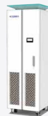
● 空間除菌機 ACSTERIA(アクステリア) 空気中に浮遊するウイルスを99.9%除菌する業務用空間除菌機です。床面積機内に250㎡まで対応可能。ファンで吸い込んだ空気に深紫外線LEDを直接照射し、空気中の微生物やウイルスを除菌します。
