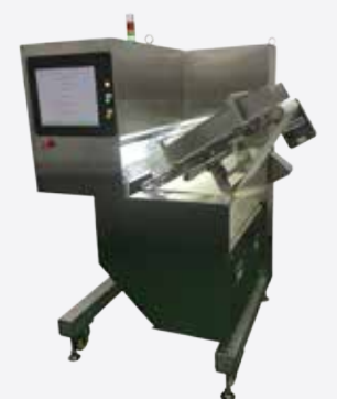
● 食品用異物選別装置 機械式と画像式の2タイプを有し、30年以上にわたって食品に含まれる異物選別の装置製造に携わっています。納入先は400社以上、1,500台以上の実績があります。
