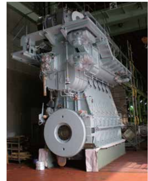
日立 MAN B&W 6S35MC 型 船用エンジン Hitachi MAN B&W 6S35MC Marine Engine
