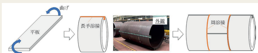
図1.1 水圧鉄管の製造工程
