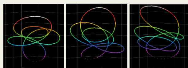
(a) (b) (c) 図9 電動機回転軸振動のリサージュ図形 計測時期 (a) 2020年8月, (b) 2021年9月, (c) 2021年12月
