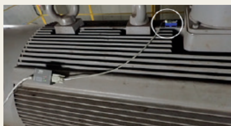
図8 加速度センサーの設置例
