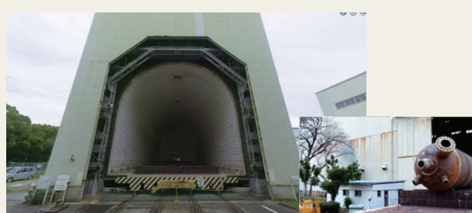
大型熱処理炉（高さ11×幅11×奥行31m）
