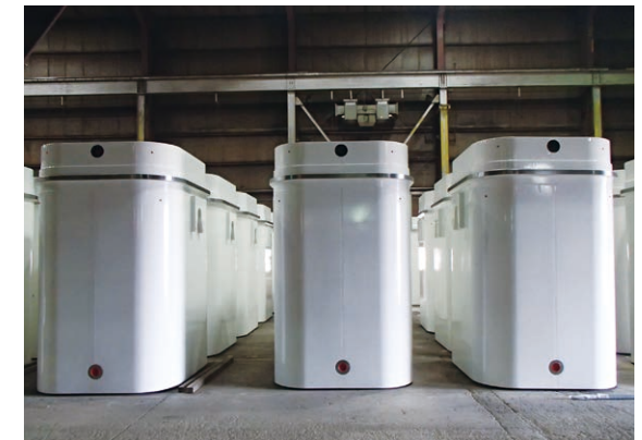
Niagara Energy Products 製造のカナダのお客様向け使用済燃料乾式貯蔵容器
