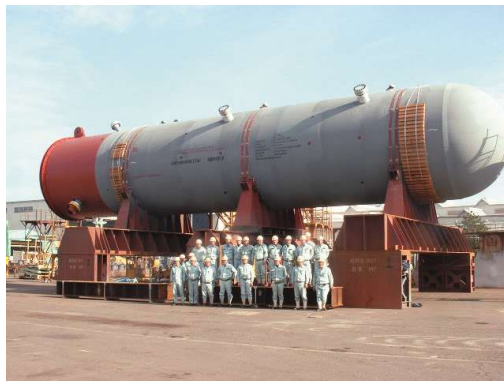
図A-1-15：圧力容器(バーレーン向け脱硫リアクター)
