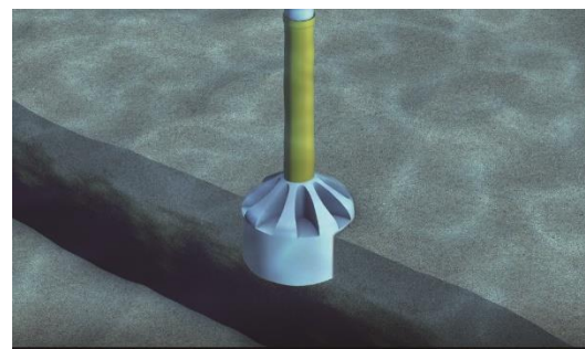
サクシヨンバケット設置断面
